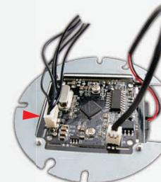
**Schritt 3:** Merken Sie sich die Position des CMOS Sensors und entnehmen Sie die Trägerplatte. Entfernen Sie vorsichtig das Kabel, welches zur Hauptplatine führt. Anschließend lösen Sie die 4 Schrauben der Sensorplatine.
