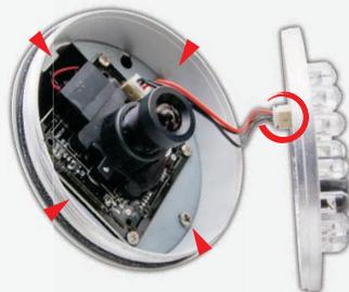
**Schritt 2:** Entfernen Sie den Schaumstoffring, entnehmen Sie die LED-Platine und ziehen Sie den Stecker von der Rückseite ab. Lösen Sie anschließend die 4 Schrauben, die die Metall-Trägerplatte fixieren.
