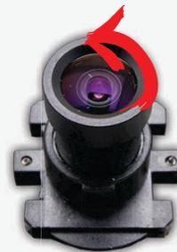
**Schritt 5:** Setzen Sie die Trägerplatte wieder in die Kamera ein, verbinden Sie die Steckverbindung und verschrauben Sie die Platine mit dem Gehäuse. Achten Sie darauf, dass keine Kabel am Gehäuse eingeklemmt werden. Drehen Sie jetzt das Objektiv heraus und ersetzen Sie es durch das Neue. Öffnen Sie die Kamera in Ihrem Webbrowser. Drehen Sie langsam am Objektiv bis das Bild die gewünschte Schärfe hat.
