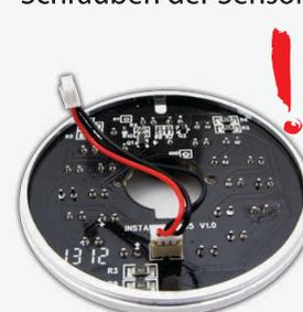
**Schritt 6:** Verbinden Sie die LED-Platine wieder mit dem Kabel und setzen Sie diese zurück auf die Kamera. Bitte berühren Sie mit der Rückseite der LED-Platine **nicht** das Kameragehäuse. Es könnte einen Kurzschluss zur Folge haben, die die LEDs zerstören. Danach den Schaumstoffring über das Objektiv stülpen, die Frontabdeckung wieder vorsichtig aufschrauben und die obere Gehäuseabdeckung auf die Kamera schieben.
