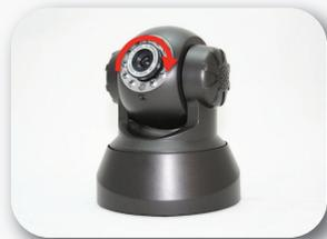
**Schritt 5:** Setzen Sie das Objektiv vorsichtig in die Kamera ein und drehen Sie es ein paar Umdrehungen nach rechts.
