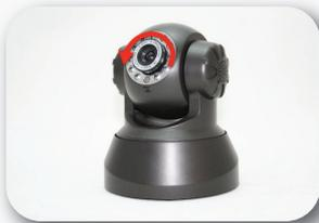
**Schritt 1:** Drehen Sie das Standardobjektiv aus der Kamera heraus, indem Sie den Fokus-Ring nach links drehen
