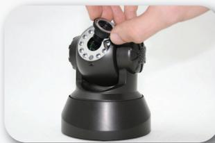
**Schritt 2:** Entfernen Sie vorsichtig das Objektiv aus der Halterung des CMOS Sensors
