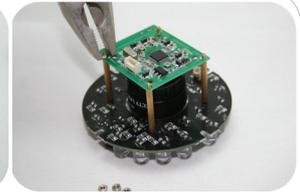
**Schritt 3:** Entfernen Sie die 4 Schrauben am äußeren Rand, welche die Infrarot Platine halten und entnehmen den Diodenring mitsamt der Optik und der CMOS Platine. Lösen Sie danach die 4 Muttern und heben die Platine mit dem 12mm Objektiv von den Abstandshaltern herunter.
