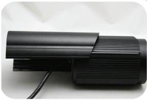
**Schritt 1:** Schieben Sie die obere Abdeckung der IN-2907 nach vorne von der Kamera herunter
