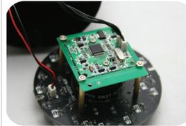
**Schritt 5:** Schrauben Sie nun das 6mm Objektiv in die Fassung. Anschliessend kann der Diodenring wieder montiert werden.
