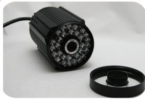
**Schritt 2:** Halten Sie die Kamera am hinteren Ende fest und schrauben Sie die Front der Kamera ab
