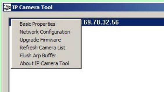
Jetzt können Sie durch Anklicken des Menüpunktes "Network Configuration" die Netzwerkkonfiguration des LAN-Anschlusses der Kamera vornehmen.
