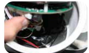
**Schritt 3:** Heben Sie den Kameraaufbau vorsichtig aus dem Gehäuse bis Sie an die Verkabelung gelangen.
