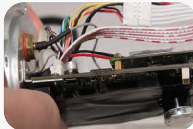
**Schritt 3:** Verbinden Sie jetzt das andere Ende des Kabels (von der Heizung) mit dem jetzt freien Steckverbinder der Hauptplatine. Setzen Sie die Heizung vorsichtig in den unteren Bereich der Kamera ein. Das Thermostat (silberner Aufsatz) muss zum Kameragehäuse gerichtet sein.
