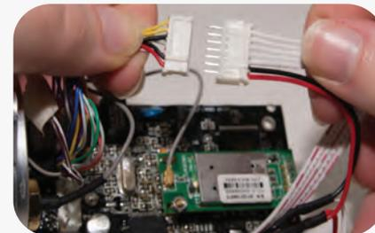
**Schritt 2:** Lösen Sie den **7-poligen** Stecker vom hinteren Teil der Hauptplatine und verbinden Sie diesen mit dem Kabel der Heizung. Bitte darauf achten, dass dies richtig und sicher sitzt.
