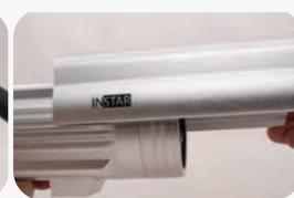
**Schritt 4:** Setzen Sie den zuvor entfernten hinteren Teil jetzt wieder auf die Kamera und achten Sie darauf, dass der **Dichtungsring** richtig sitzt. Nachdem Sie die 4 Schrauben wieder richtig festgezogen haben, schieben Sie bitte die obere Abdeckung wieder auf Ihre Kamera.
