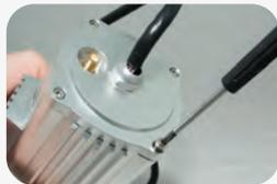
**Schritt 1:** Schieben Sie die obere Abdeckung der IN-2904/5/6/7 nach vorne von der Kamera herunter. Entfernen Sie mit einem Inbusschlüssel die 4 Schrauben am hinteren Teil der Kamera.
