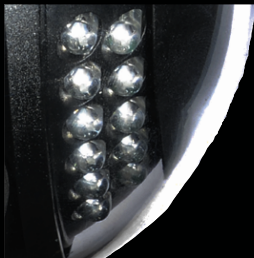
Nachtsicht mit 22 Infrarot LEDs
