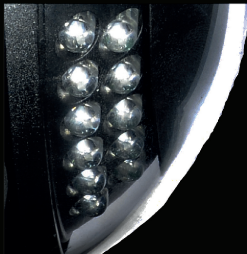
Nachtsicht mit 22 Infrarot LEDs
